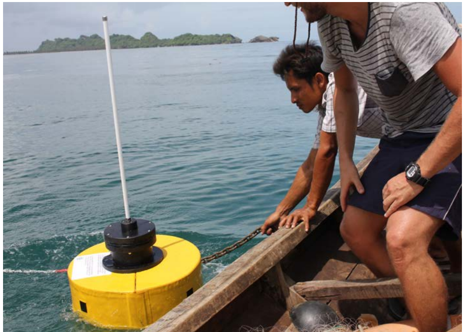
De innovatieve boei van Wavedroid meet de hoogte, richting en frequentie van golven.
